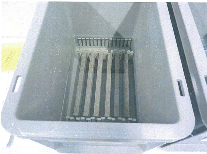
Bild 1: in Prüflösung eingelagerte Probekörper (Beispiel)
