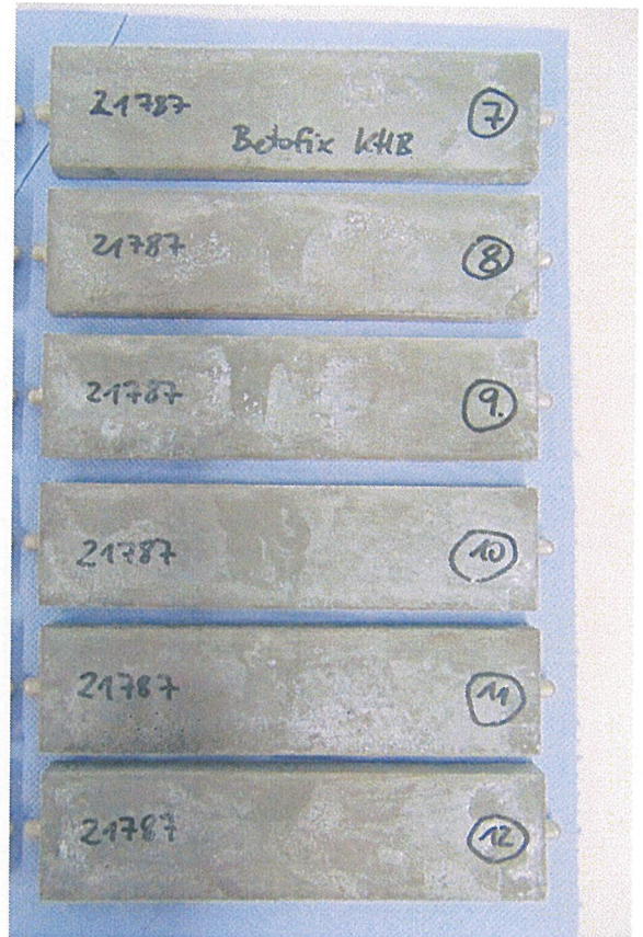
Bild 3: Probekörper nach 91 Tagen Lagerung in Sulfatlösung
