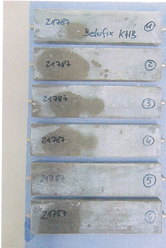
Bild 2: Probekörper nach 91 Tagen Lagerung in gesättigter \text{Ca(OH)}_2 -Lösung
